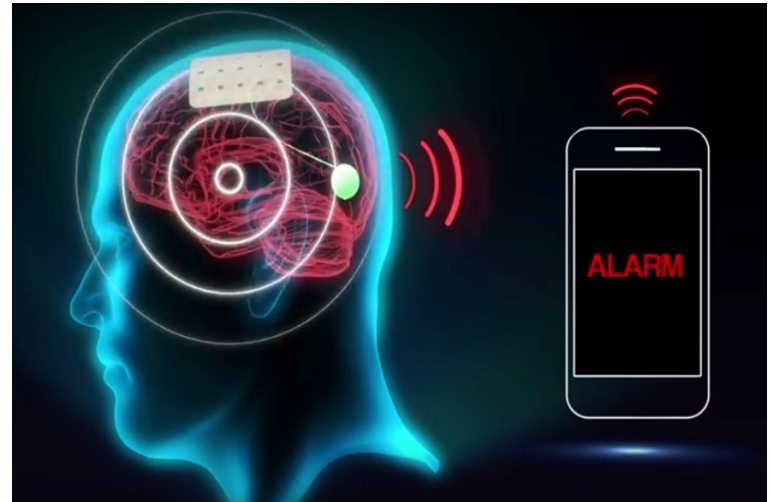
Figura: Exemple de nanotecnologia: dispositiu basat en sensors de grafè per a la detecció d'atacs d'epilèpsia, desenvolupat pel grup del professor ICREA José A. Garrido a l'ICN2, i els seus col·laboradors (Rosa Vila, CNM-IMB-CSIC i CIBER-BBN, i María Victoria Sánchez Vives, ICREA i IDIBAPS).
